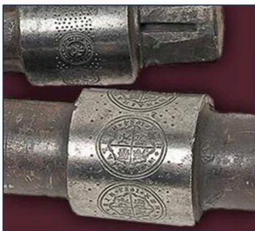
Rodillos utilizados para la acuñación de moneda
