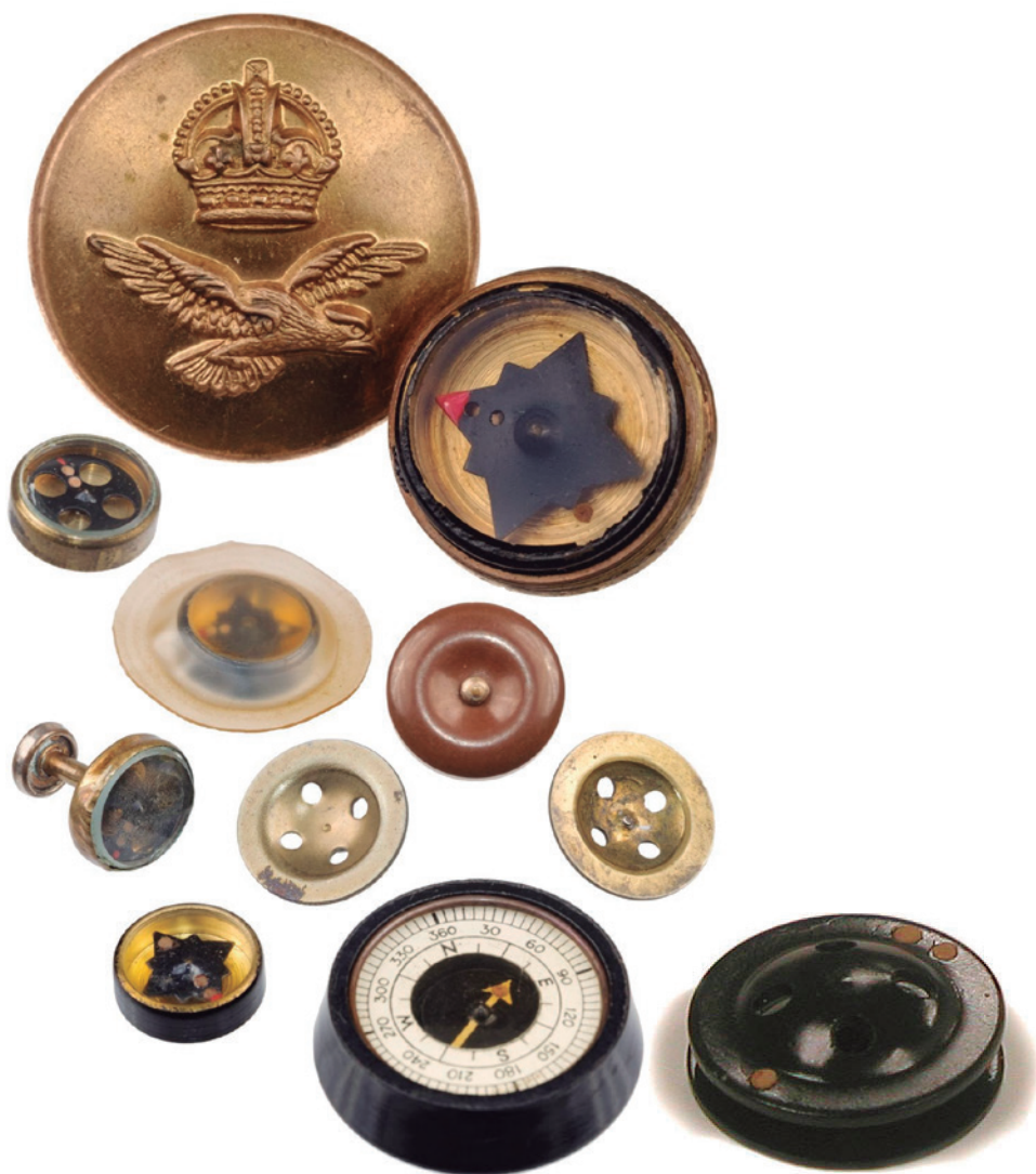
Figura 3. Miscelânea de botões da RAF (Royal Air Force) e do exército britânico durante a Segunda Guerra Mundial (1939-1945). Esses botões possuíam uma função utilitária: uns continham bússolas escondidas em seu interior, outros formavam uma bússola com a junção de dois botões. Funcionava da seguinte forma: o botão inferior tem uma pequena agulha no meio que se projeta para cima. Quando equilibrado na agulha, o botão superior gira no campo magnético da Terra até que os dois pontos radioluminescentes (dois pequenos círculos que brilham no escuro) indiquem o norte. O ponto único aponta para o sul (Vide imagem abaixo). Essas peças eram chamadas de "Escape & Evasion button" (botão de fuga e evasão) e foram projetadas para ajudar aviadores abatidos a se orientarem no território inimigo, auxiliando uma possível fuga. Fonte: Oak Ridge Associated Universities (ORAU) Museum of Radiation and Radioactivity ( orau.org ); Dominic Winter Auctioneers ( dominicwinter.co.uk ).
