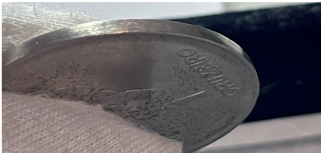
Figura 12 - moeda adulterada com marcas de linhas de lixamento e de brilho após polimento
