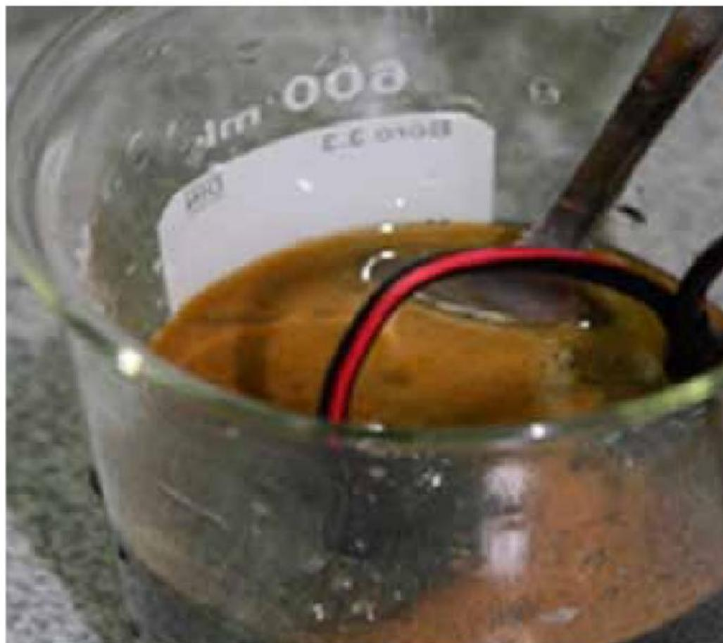
Solución saturada de productos de la corrosión, incluido el óxido de hierro
