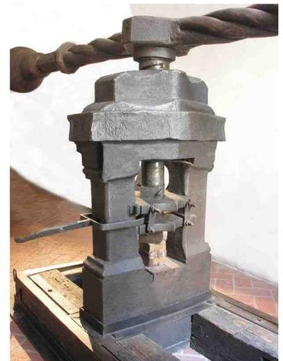
*Funcionamiento de una prensa de volante*
